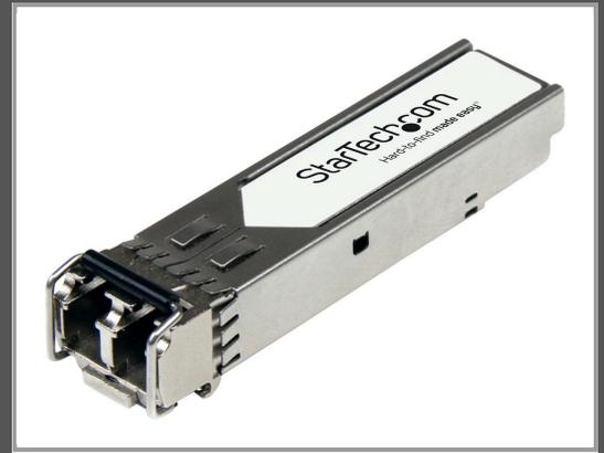
SFP+-Transceiver-Modul (gleichwertig mit: Extreme Networks 10301) - 10GbE - 10GBase-SR - LC Multi-Mode - bis zu 300 m - 850 nm
